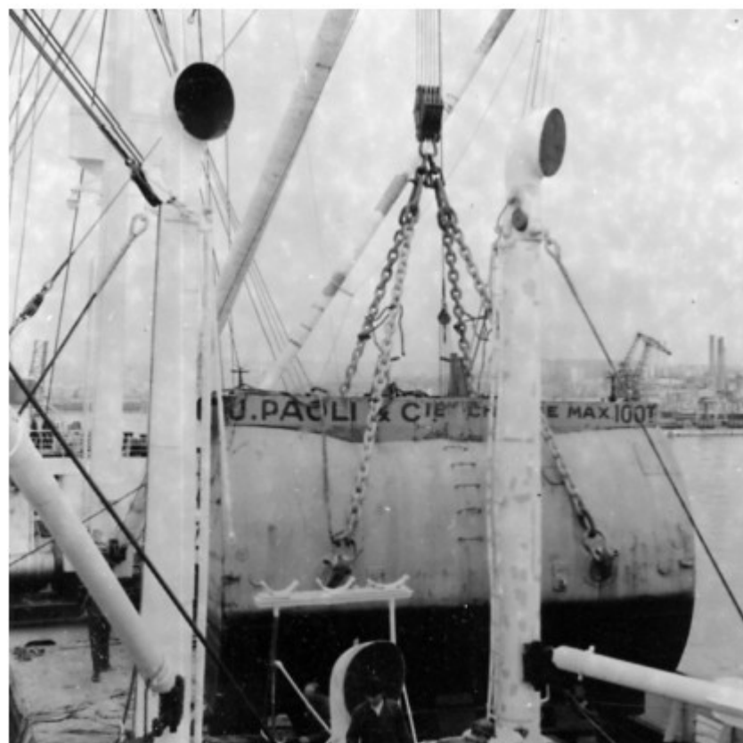
L'albero ed il bigo di forza vengono testati con un serbatoio di acqua. Con il riempimento di acqua nel serbatoio tarato si può determinare l'esatto peso per il test
