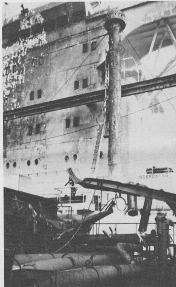
Die beiden Hälften des Lukendeckels Nr. 11 wurden durch die Druckwelle meterhoch in die Luft geschleudert. Eine Hälfte flog über Bord, die andere fiel zurück in die Luke und blieb am Süll verkantet hängen. (Gewicht 90 Tonnen!)
