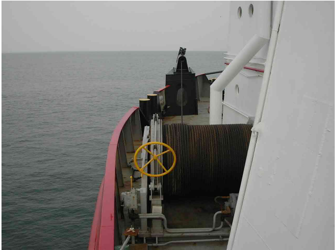
Anordnung der backbord Ankerwinde vorne / Arrangement of the forward portside anchor winch
