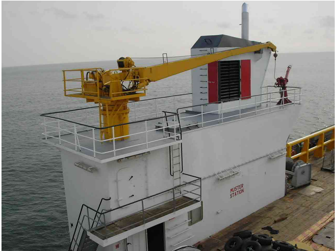
Der achtere Schornstein mit dem Kran (konstruiert beim Umbau in Texas) / The aft funnel starboard with the crane (built during conversion in Texas)
