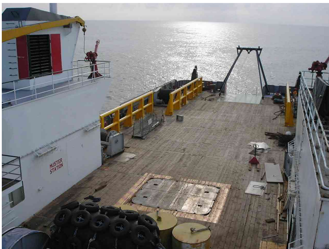
Das Arbeitsdeck, bemerke auch die beiden Feuerlöschmonitore und die Luke zum Unterraum (Wellentunnel) The working deck, note also the two fire monitors and the hatch to the lower hold (shaft tunnel)
